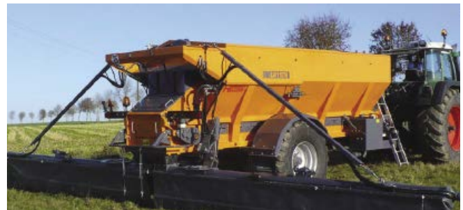
Abb. 5: Kalk- und Aschestreuer mit Streuschnecken
